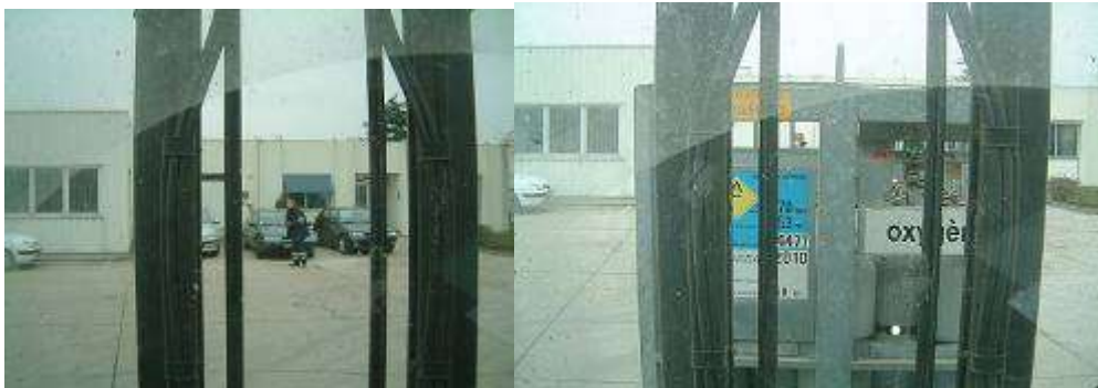
Figure 14: Mauvaise visibilité lors du transport de panier de bouteilles ou de cadres
